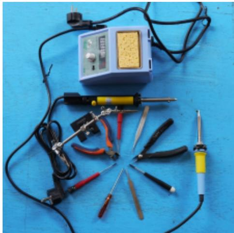
d'essai, du fil conducteur, un fer à souder, une pompe à des-souder, des tournevis, une petite pince précelle et une pince coupante, une troisième main, et de l'étain.
