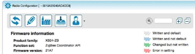
Toujours pour ce module XBee, il nous faut descendre dans la liste des paramètres et sélectionner « 2 » pour le paramètre « API enable parameter » et le sauvegarder dans la radio XBee à l'aide du bouton de droite :
