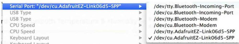
Si vous n'obtenez pas ce nouveau port dans la liste, fermez et ré-ouvrez Arduino IDE. Si le module Bluetooth est bel et bien jumelé avec votre ordinateur, il n'y a aucune raison qu'il n'apparaisse pas dans la liste.
