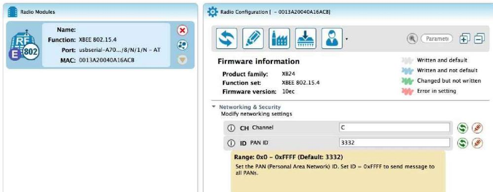
Depuis ce menu, vous pouvez définir le « PAN ID » du module XBee branché à la carte XBee Explorer. Il vous suffit de répéter l'opération pour chacun des modules XBee que vous souhaitez configurer.
