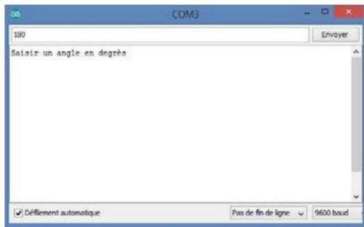
Figure 9-7. Commande de la position du servo à l'aide du moniteur série
