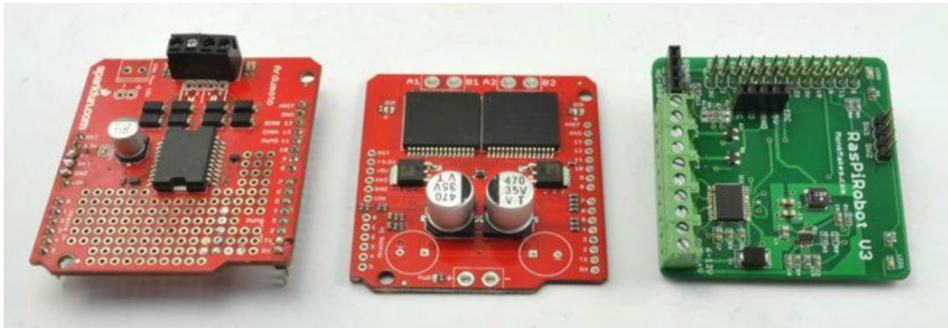
Figure 8-16. Shields de ponts en H pour Arduino et Raspberry Pi
