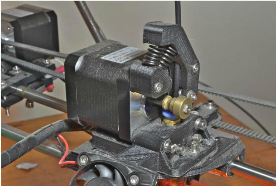
Figure 10-1. Le moteur pas-à-pas d'une imprimante 3D
