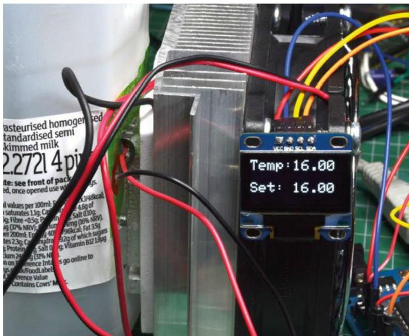
Figure 14-10. Ajout d'un écran OLED au projet de réfrigération de boisson
