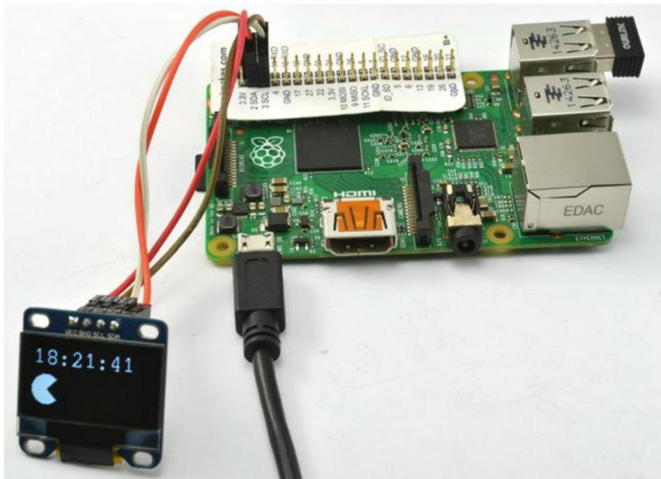
Figure 14-8. Une horloge à écran OLED
