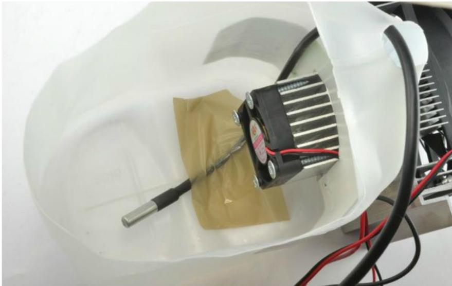
Figure 12-19. Ajout de la sonde de température
