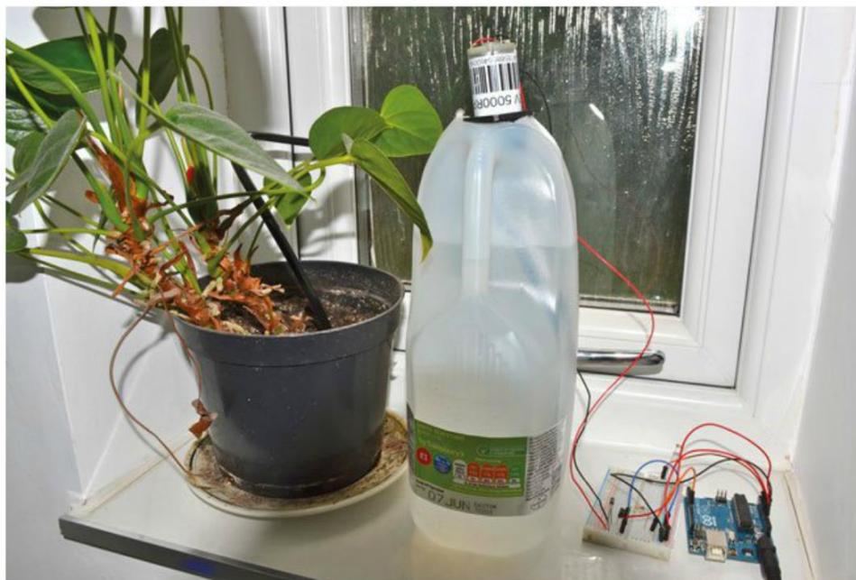
Figure 7-16. Système d'arrosage pour plantes d'intérieur
