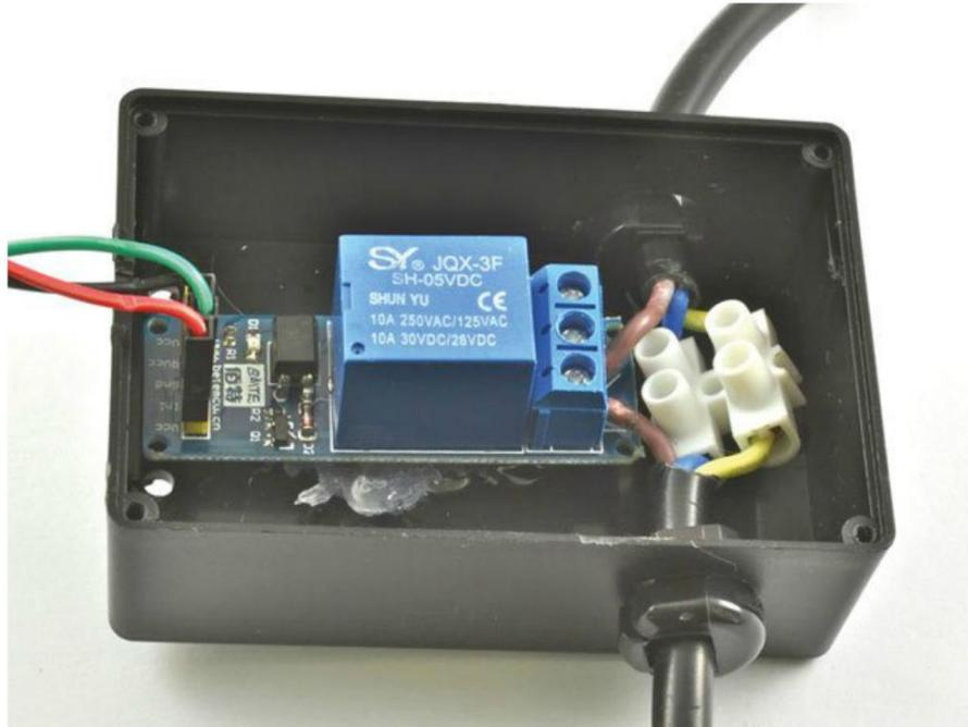
Figure 13-6. Un module relais dans une boîte en plastique
