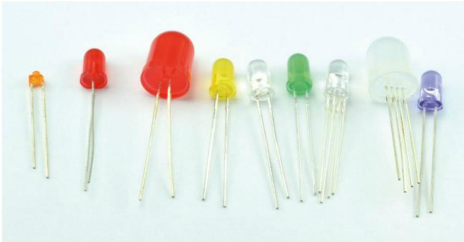
Figure 6-1. Une sélection de LED
