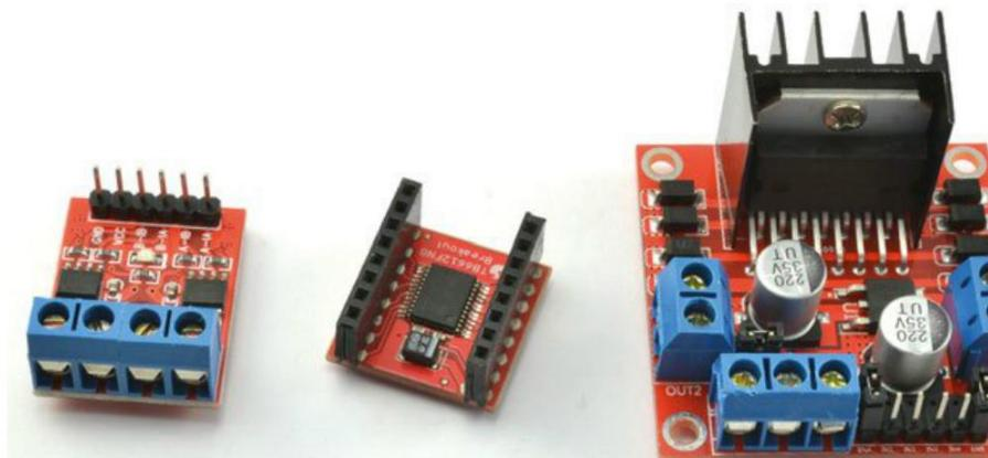
Figure 8-15. Modules à ponts en H
