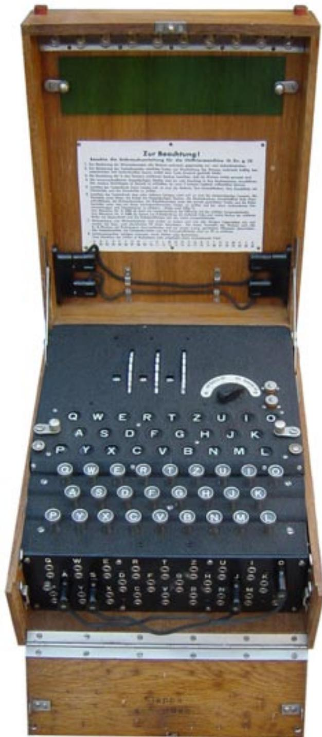
1940 : ENIGMA, machine électro-mécanique portable à base de cylindres pour le chiffrement et le déchiffrement de l'information, créée dès le début des années 1920, et utilisée massivement par l'armée nazie.
