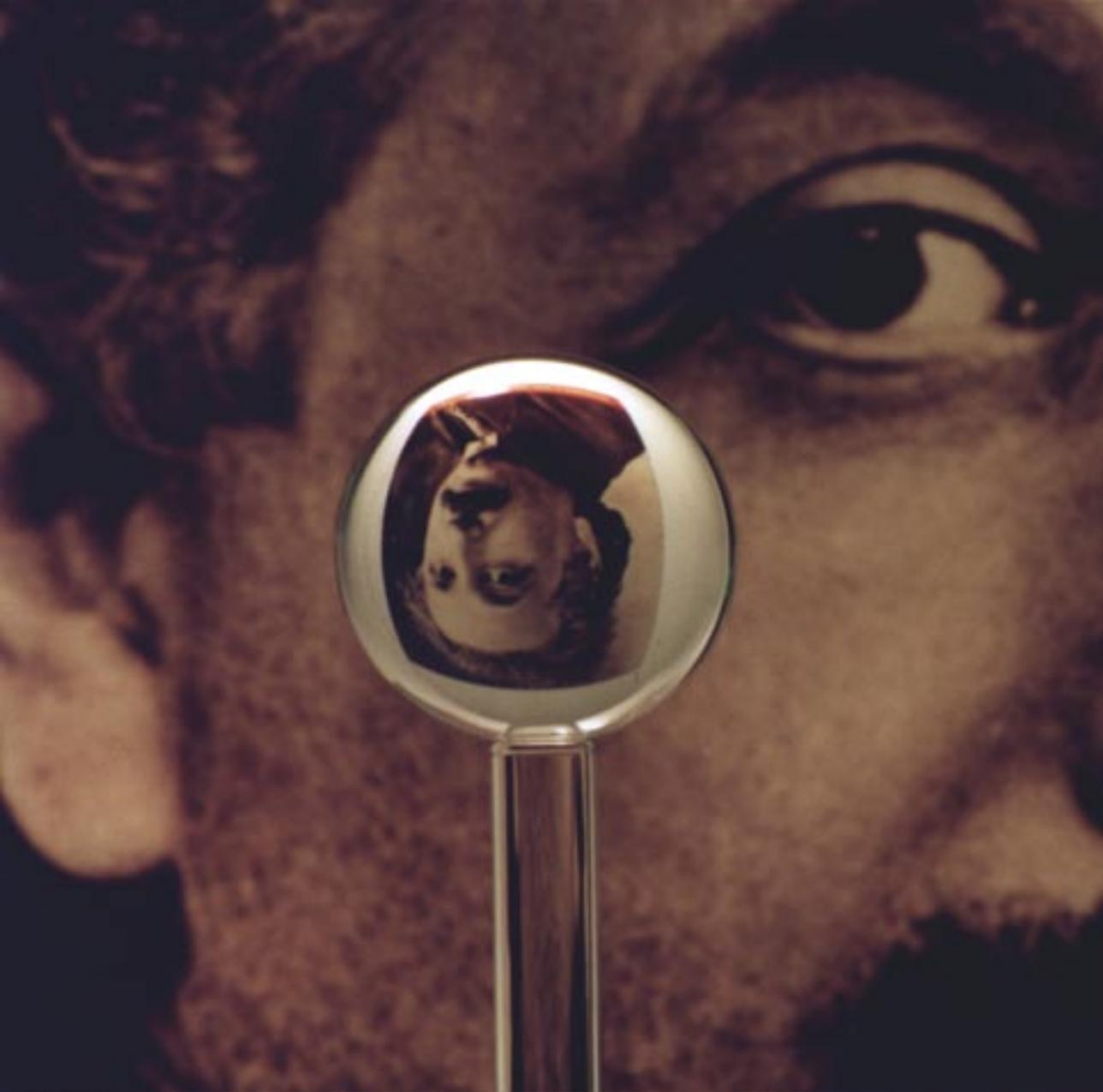
Une des sphères les plus parfaites jamais créées par l'homme (ici, reflétant l'image d'Einstein) : un gyroscope de quartz fondu réalisé pour l'expérience «Gravity Probe B».
